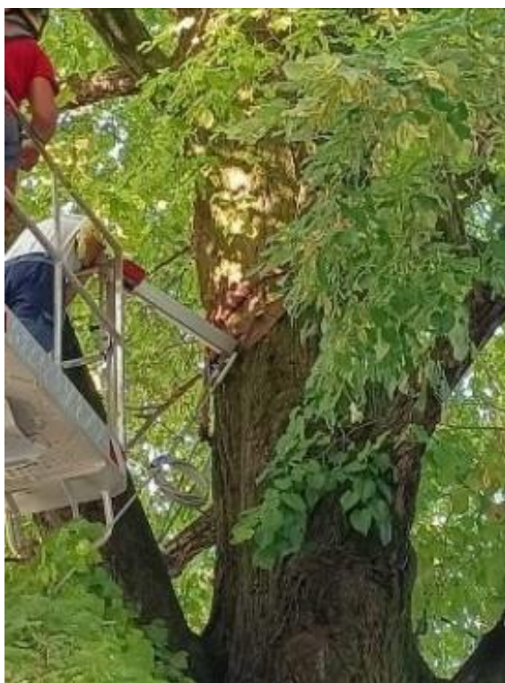
Figura 32: prova penetrometrica in quota con piattaforma di lavoro elevabile - PLE. Mogliano Veneto, 28/09/2021. Fonte: Ferrarini R.
