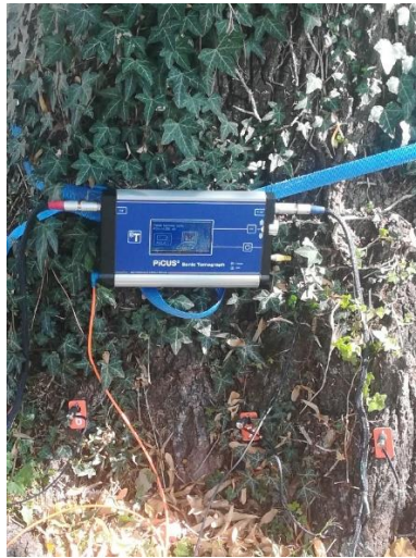
Figura 10: tomografo sonico Picus®. Fonte: Cadamuro M.
