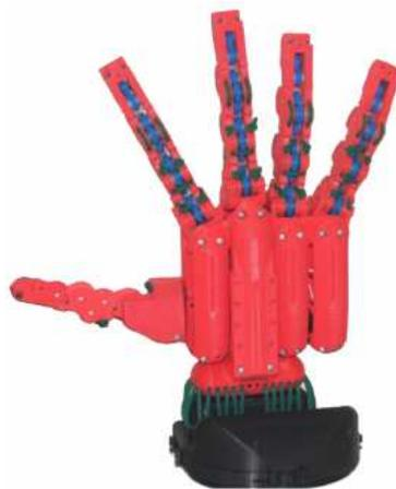
**Figura 1.1:** Prototipo di Pisa/IIT SoftHand di dimensioni comparabili a quelle di una mano umana.
