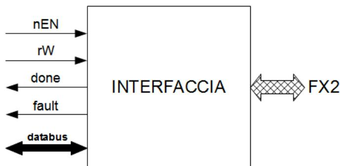
Figura 4.1.1. Schema dell'interfaccia secondo le specifiche.
