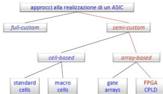
**Figura 1.2.1.** Approcci alla realizzazione di un ASIC.
