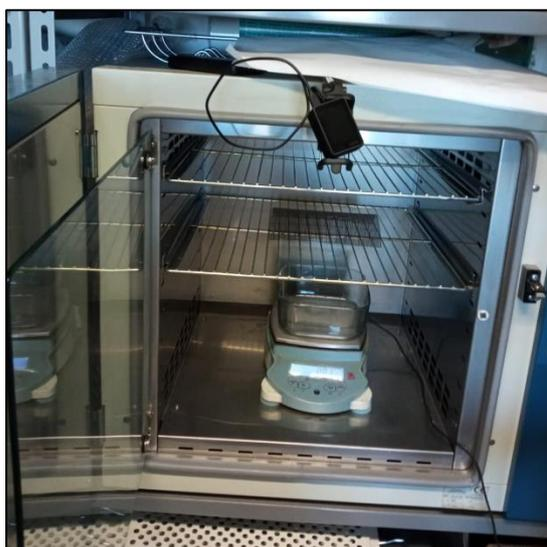
Camera termostata impiegata nelle prove con annessi: griglia e retina per il gelato, bilancia, contenitore per il gocciolato e videocamera per riprendere il peso del gocciolato durante i 60 min di prova.
