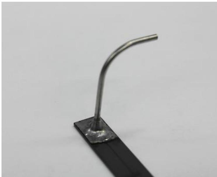
*Figura 2.25 Tubo da 1/16" saldato con stagno al microcanale e ricoperto di colla*
