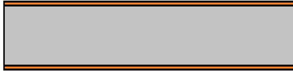
Figura 2.8 Wafer di silicio dopo ossidazione termica
