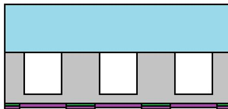
Figura 2.20 Deposizione di titanio e platino (20/200 nm)
