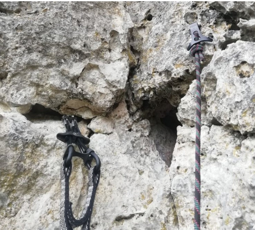
Fig. 7: friend e cliff usati per stabilizzarsi durante il campionamento
