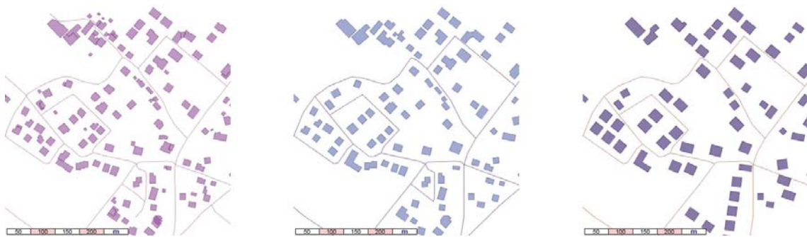
Figura 5.1: Generalizzazione dell'edificato: in questa serie di tre immagini si possono osservare le trasformazioni subite dall'edificato con il cambio di scala. Nell'immagine centrale si può vedere che i dati originali sono stati semplificati accorpendo edifici adiacenti o limitrofi e semplificandone la forma; solo gli edifici più piccoli sono stati eliminati. Nell'immagine a destra si può notare invece come l'insieme degli edifici sia stato radicalmente trasformato: alcuni edifici sono stati eliminati mentre altri sono stati spostati; gli edifici in genere non sono solo più regolari ma sono anche più grandi ed hanno uno spazio maggiore intorno a loro stessi.
