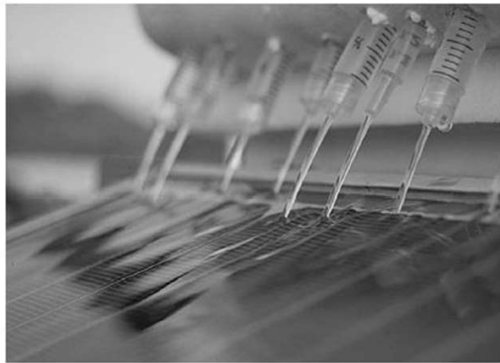
Figura 1.17: Distribuzione dell'acqua sulla faccia frontale del pannello da parte dei 12 ugelli [22].
