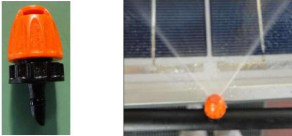
Figura 3.8: Ugello usato per spruzzare l'acqua (sinistra). Angolo di spruzzamento pari a 90^\circ (destra).
