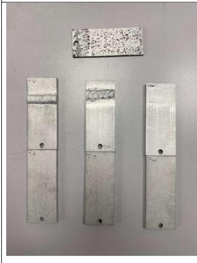
Da quest'immagine possiamo osservare i nostri campioni di saldatura confrontati con il campione denominato 'testimone' che presenta un alto grado di corrosione.
