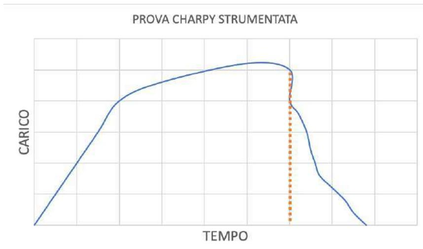
FIGURA 22 GRAFICO PROVA DI CHARPY STRUMENTATA
