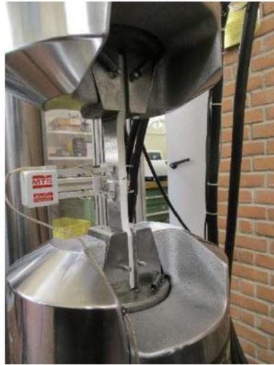
FIGURE 30A E 30B MACCHINARIO PER ESEGUIRE IL TEST DI TRAZIONE
