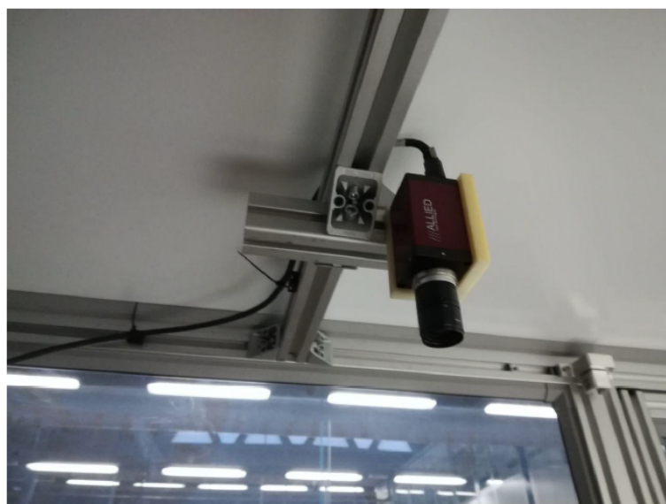
Figura 3.10: Telecamera Pike utilizzata nei test di guida robot.
