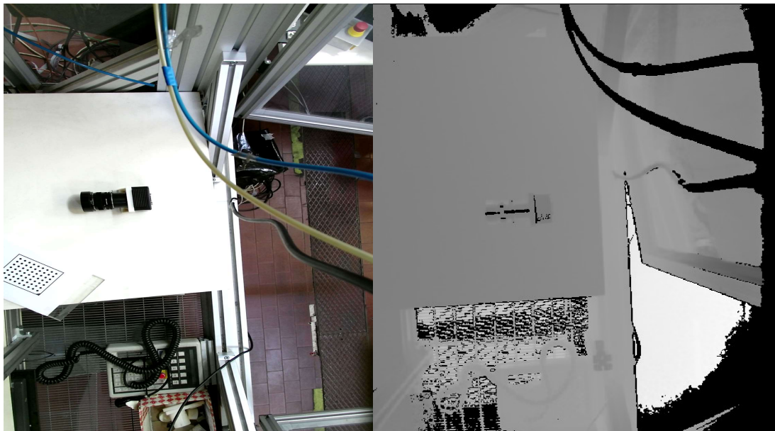
Figura 3.19: Foto della scena acquisita tramite il sensore RGB del kinect a sinistra mentre a destra dal sensore di profondità.
