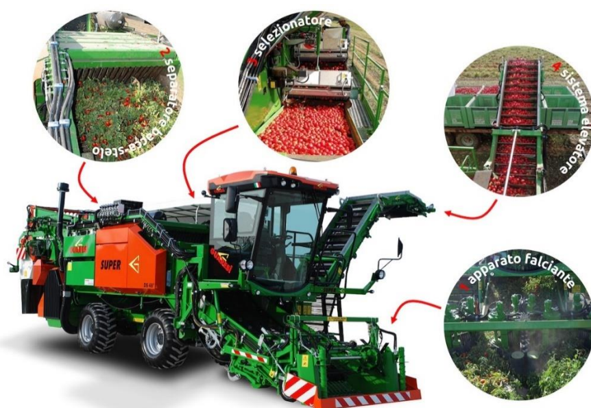
Figure 3 - The main systems on board a self-propelled harvester for processing tomatoes ( Tecnologie e meccanizzazione: I segreti del pomodoro da industria )
