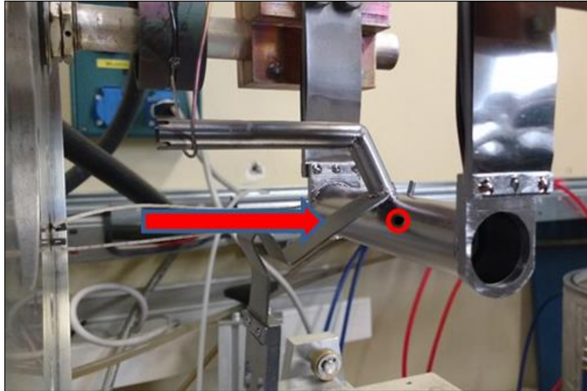
Figura 3.27: Primo punto di misura sul riscaldatore.
