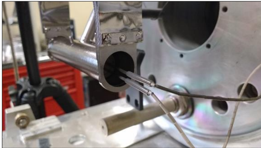
Figura 3.25: Le due termocoppie alloggiare nel dumper all'interno della scatola target.
