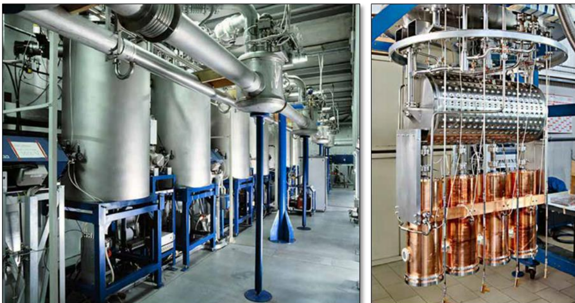
Figura 1.17: A sinistra un tratto del linac ALPI, con in evidenza i criostati; a destra l'interno di un criostato con 4 cavità acceleranti in Rame.
