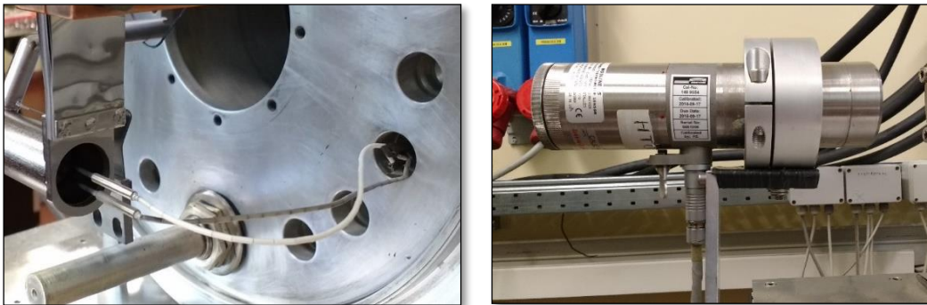
Figura 3.20: A sinistra le due termocoppie, a destra uno dei due pirometri.
