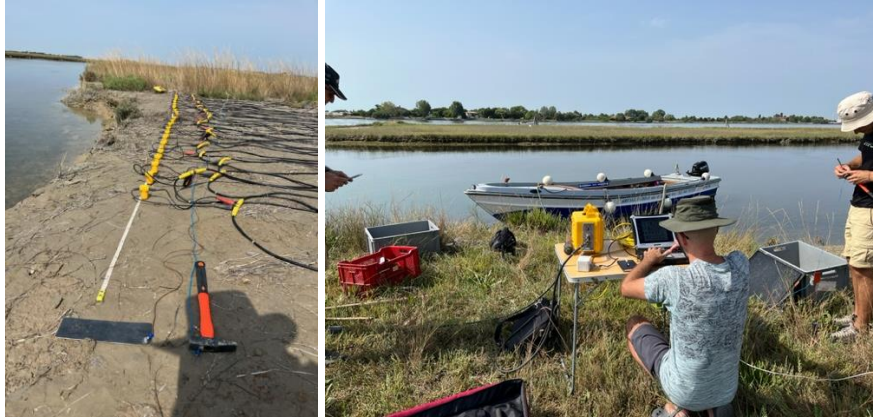
a) Martello e land streamer su suolo nudo: geofoni posizionati sulle piastre, legate tra loro tramite fascia
