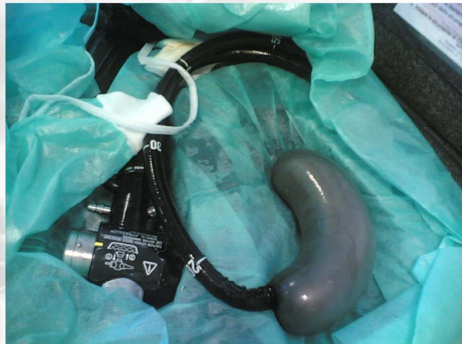
Figura 1.9: Risultato di una manutenzione non correttamente eseguita e con l'impiego di materiali non idonei. Nell'immagine è evidente la compromissione della funzionalità immissione e aspirazione aria/acqua dell'endoscopio, la quale può diventare estremamente pericolosa durante l'esecuzione dell'esame endoscopico.
