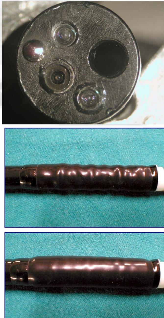
Figura 1.8: Risultati di una manutenzione non correttamente eseguita e con l'impiego di materiali non idonei. Nella prima immagine sono presenti dei vuoti intorno alle uscite sulla punta del distale, mentre nella seconda immagine è evidente un rigonfiamento anomalo della guaina del tratto angolabile.
