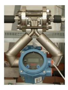
Figura 2.3: misuratore di portata Coriolis [4]
