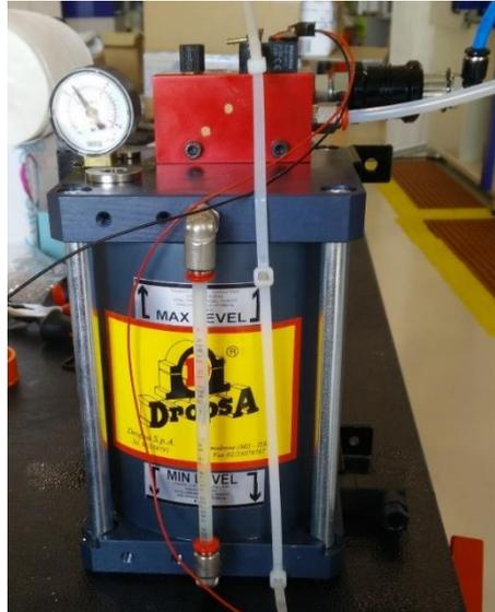
**Figura 4.13** Sistema MQL, composto da serbatoio, manometro, sistema di regolazione del flusso di olio e della pressione
