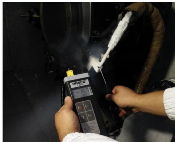
*Figura 4.10* Misurazione della temperatura del refrigerante tramite termocoppia
