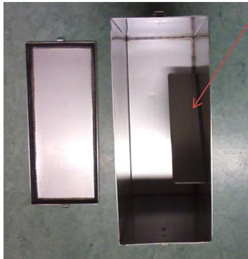
Figura 3.4.1 Contenitore usato per la misura della durabilità.
