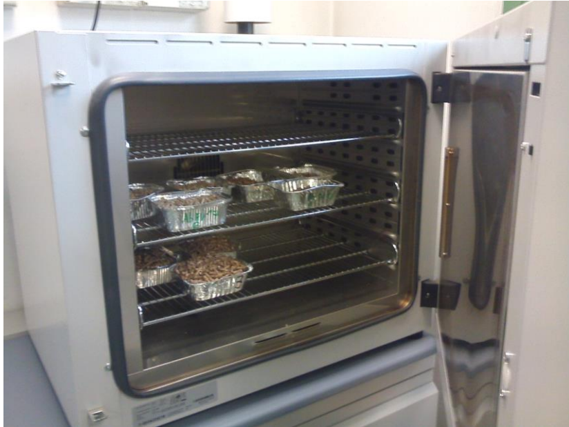
Figura 3.2.1 Alcuni campioni in stufa per la misura del contenuto idrico.
