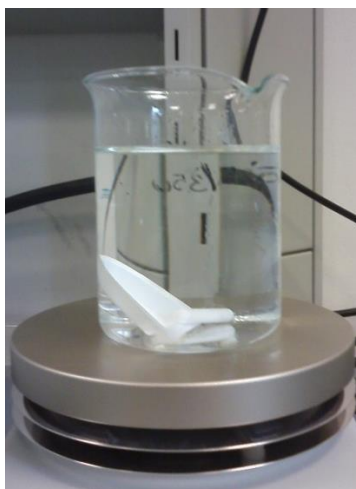
Figura 3.3.1 Becher usato per la preparazione della soluzione sopra l'agitatore magnetico (all'interno del becher: Ancoretta magnetica e piattino usato per pesare il Triton)
