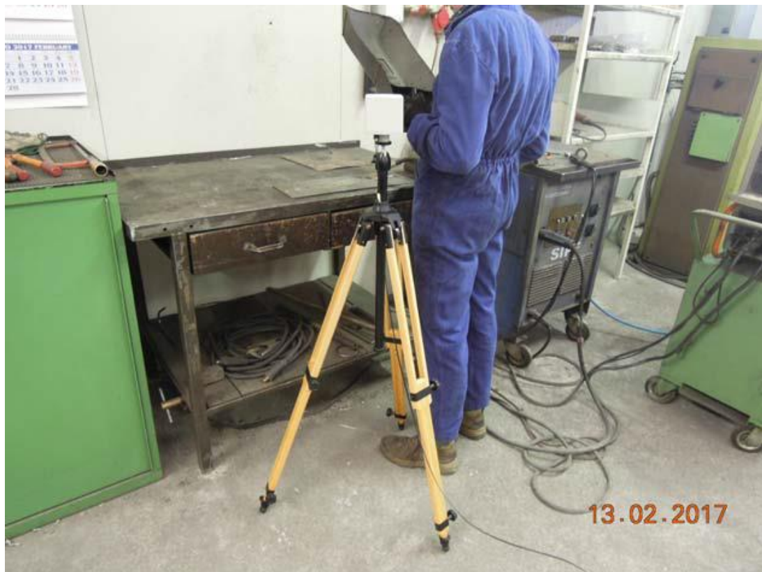
Immagine della sorgente di Campi Elettromagnetici in esame e le fasi di misura.
