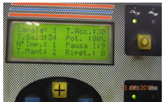
Caratteristiche dell'apparecchiatura e particolare dei parametri impostati al pannello di controllo durante le operazioni di misura
