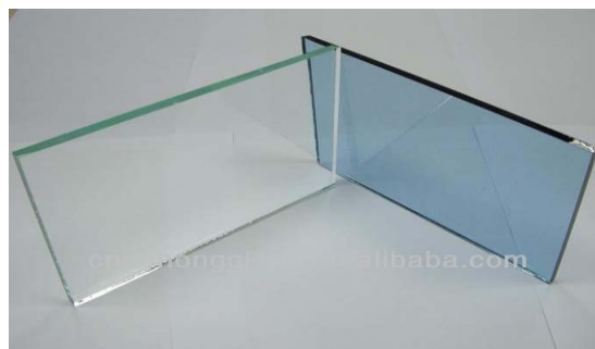
Figura 1.3: vetro normale (a sinistra) e basso emissivo a confronto
