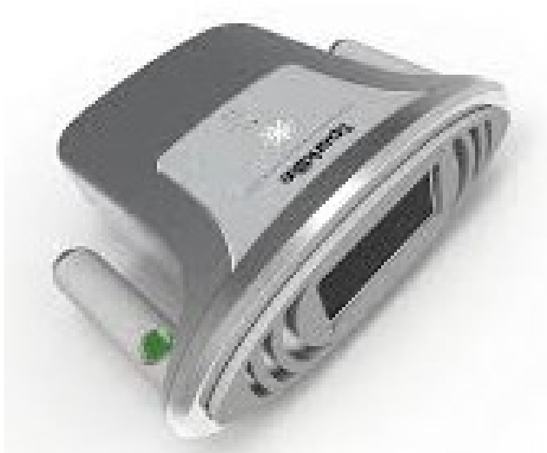
Fig. 3.8: vista frontale della testa di misura. Si noti la ventosa attorno al pannello di vetro centrale.
