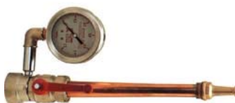
Figura 7.5 – Strumento per la misurazione della pressione statica e della pressione residua
