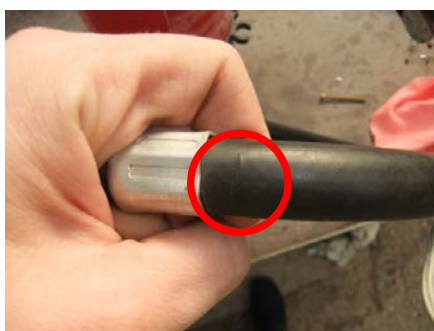
Figura 7.1 – Danno al tubo flessibile di un estintore a polvere
