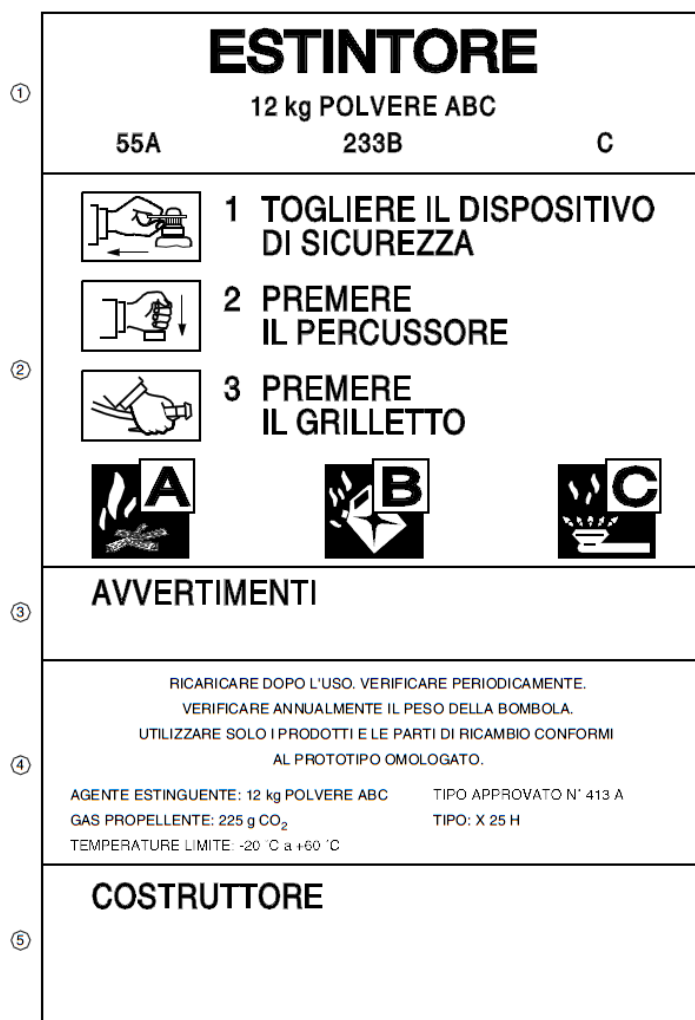
Figura 6.13 – Esempio etichetta estintore (UNI EN 3-7)
