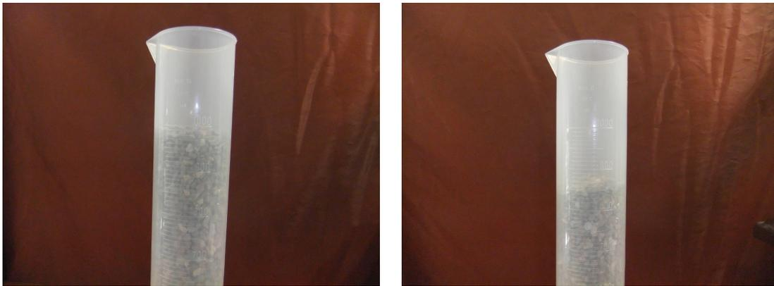
Figura 5.8: A sinistra, la ghiaia fine disposta nel cilindro in condizioni definite di massima porosità; a destra, la stessa massa in condizioni di massimo compattamento a seguito di vibrazione manuale applicata al cilindro.
