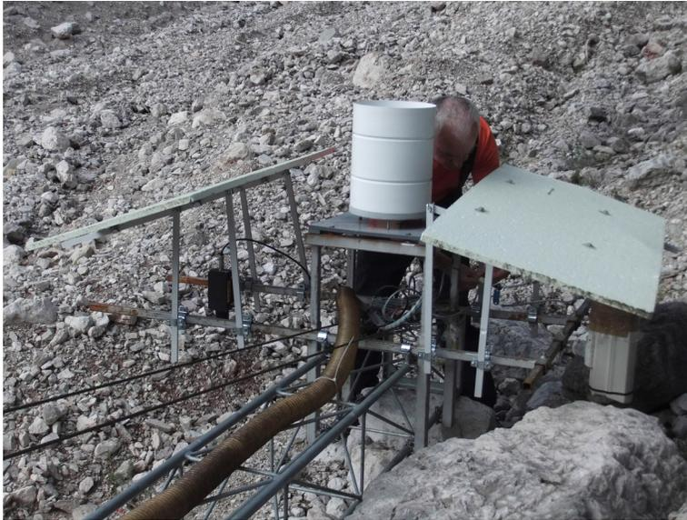
Figura 4.3: Strumentazione esterna della stazione di valle. Sono visibili un pluviometro a basculante, una telecamera ed un laser.
