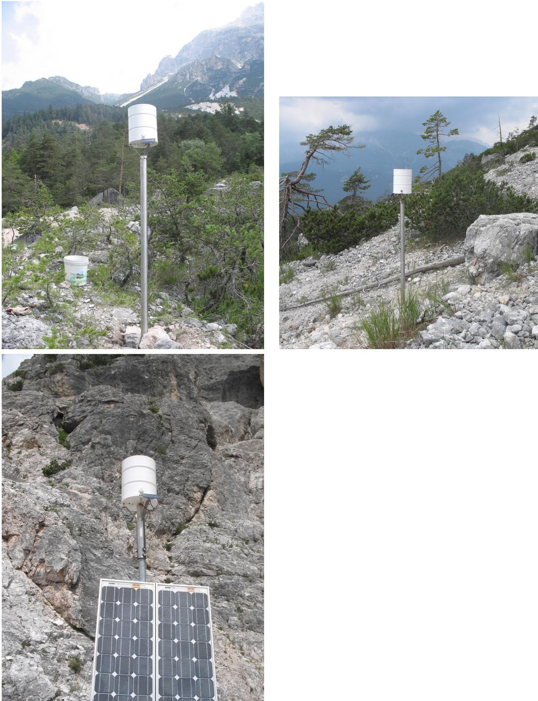
Figura 4.14: Assetto dei tre pluviometri. In alto a sinistra è visibile il pluviometro di valle, a destra quello di mezzo ed in basso a sinistra quello di monte.
