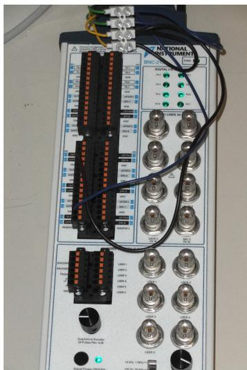
Figura 5.5: Trigger esterno che, assieme al software Labview, garantisce la contemporaneità degli scatti delle videocamere.
