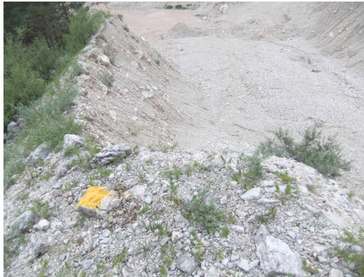
Figura 4.17: Un control point predisposto per l'analisi fotogrammetrica del canale di colata.
