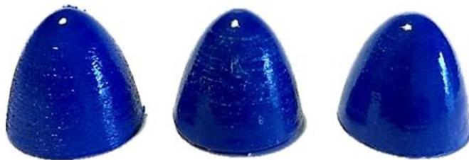
Figura 4.13: *Trattamento con sfregamento (a), immersione (b), vapori di acetone (c).*
