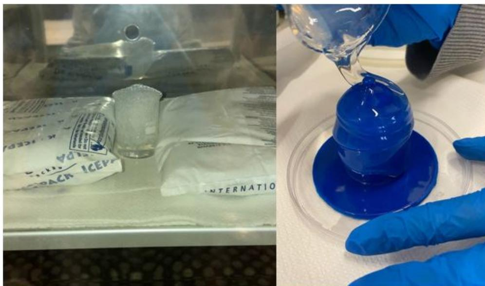
Figura 4.19: procedura di degasaggio e colatura del materiale siliconico
