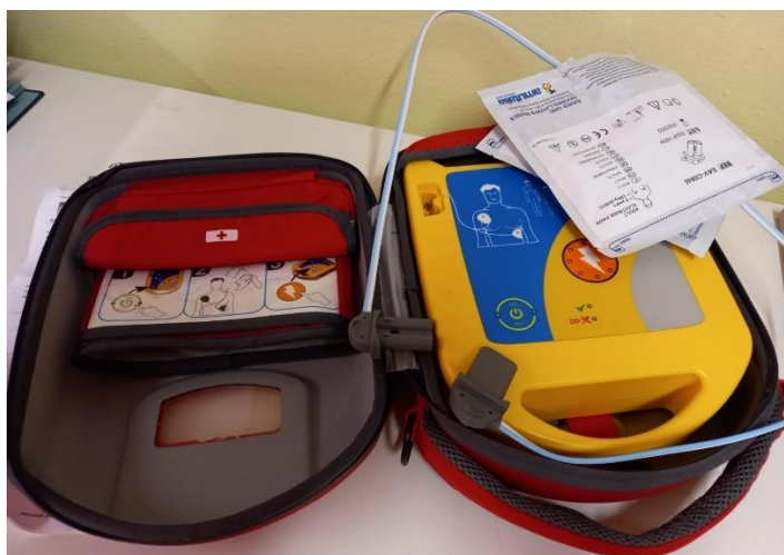
Figura 10. Defibrillatore portatile Saver One 200J semi-automatico, destinato al reparto di Radiologia, in manutenzione presso l'Ufficio Tecnico.
