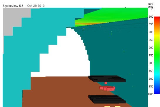
Fig 26: immagini tratte da Smokeview per la simulazione 5: da notare la scomparsa del legno (in marrone) dal dominio calcolo una volta bruciato
