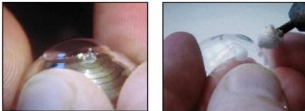
Figura 11. Creazione manuale dei fori su una lente sclerale. (S. Sciacca, Lenti a contatto sclerale RGP, Lampi di stampa, 2012)
