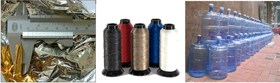
Figura 1.3: esempi applicativi del PET: film polimerico , spolette in Dacron, boccioni per acqua minerale.
