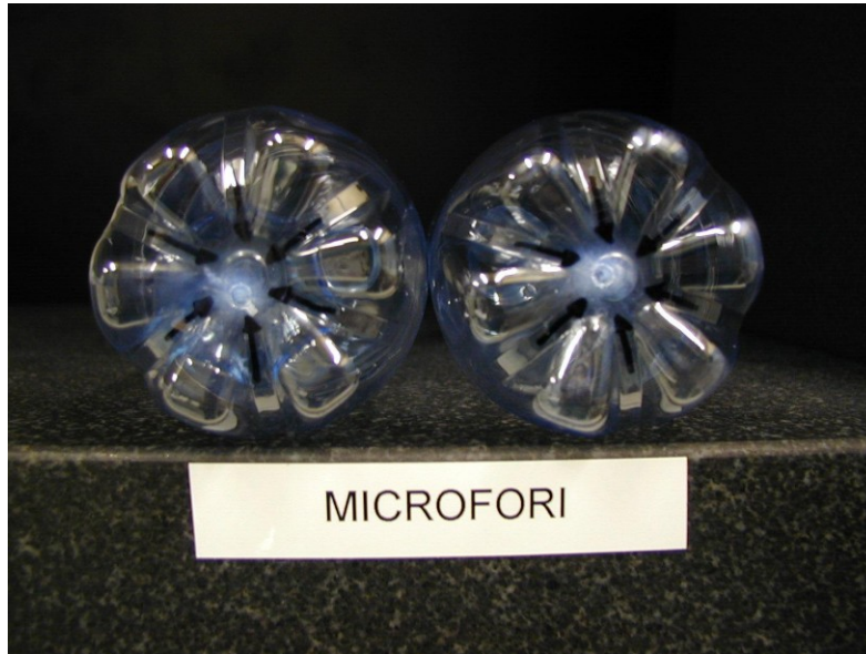
Figura 6.5: Microfori nelle bottiglie. Un corretto condizionamento termico della preforma permette la distribuzione omogenea degli spessori in fase di soffiaggio, evitando la formazione di fori.
