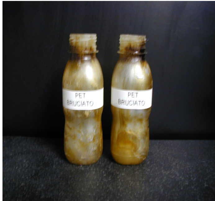
Figura 6.4: Il mantenimento prolungato ad alte temperature comportano la degradazione termica del materiale: le bottiglie prodotte risultano bruciate.
