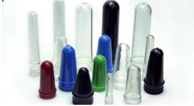
Figura 3.3: preforme in PET di varie colorazioni e forme
