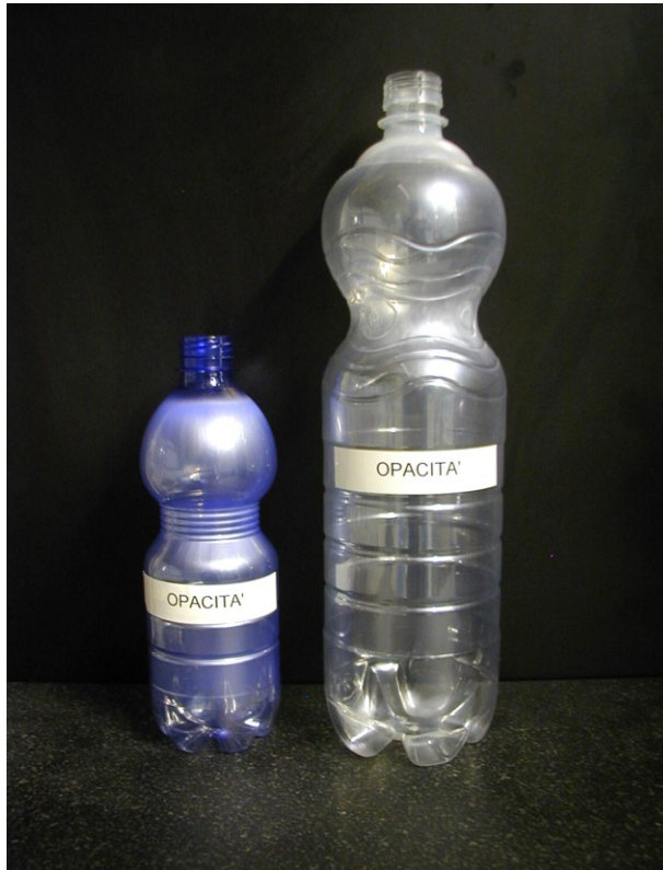
Figura 6.3: Bottiglie prodotte impiegando PET parzialmente essiccato: assumono una colorazione bianco opaca.
