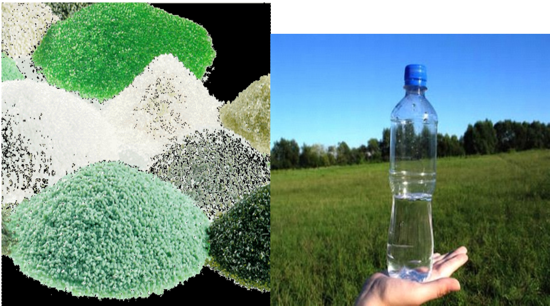
Figura 1: A sinistra, granuli di PET vergine di diverse colorazioni; a destra, una bottiglia per acqua minerale.
