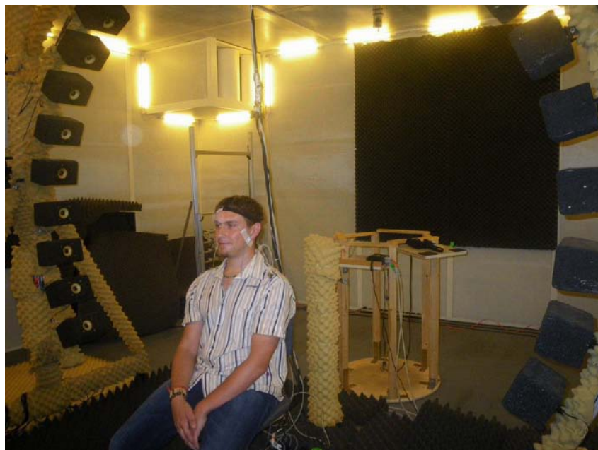
Figura 1.5: Configurazione per la misura di HRTF all'Acoustics Research Institute, Austrian Academy of Sciences, Vienna. Immagine tratta da [16].
