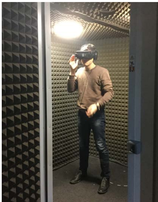
Figura 4.1: Condizioni dell'esperimento: il soggetto si posiziona al centro della camera insonorizzata con la luce spenta per tutta la durata del test.
