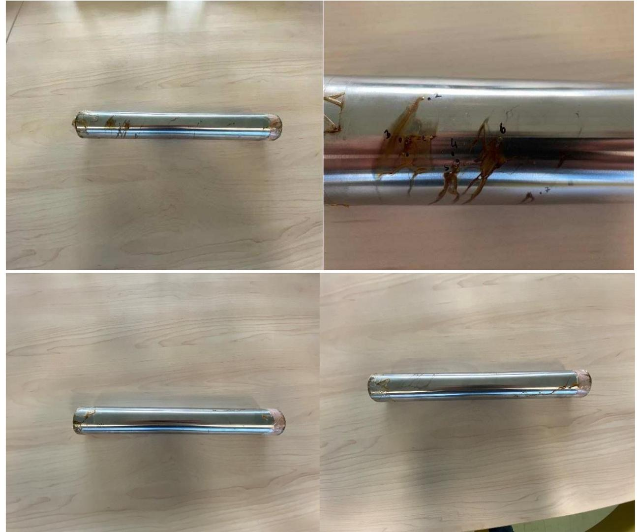
Il test a nebbia salina viene regolato tramite procedure internazionali. Essa riporta i parametri di svolgimento della prova con le relative concentrazioni, pH e la procedura pratica per eseguire il test. Le due norme di riferimento prese in considerazione sono:
