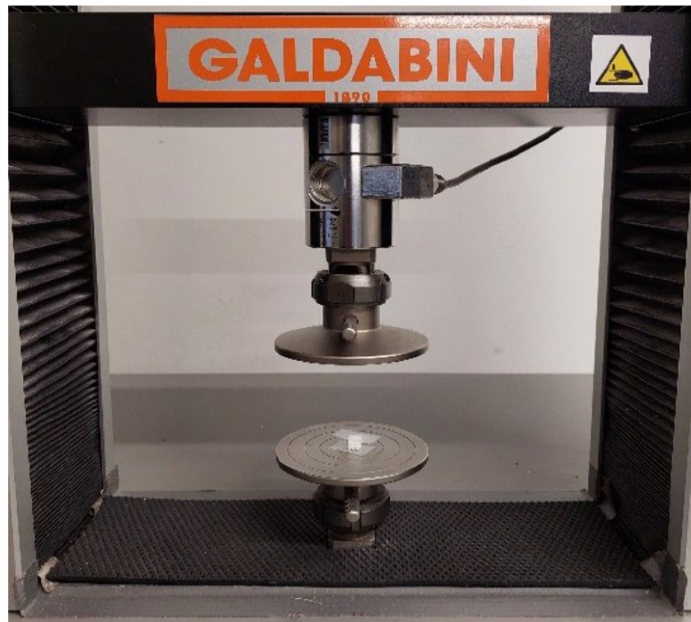
Figura 2.9 Set-up sperimentale per le prove di compressione. Il campione viene posizionato fra i due punzoni della pressa: quello inferiore è fisso mentre quello superiore si muove alla velocità di 0,5 mm/min.
