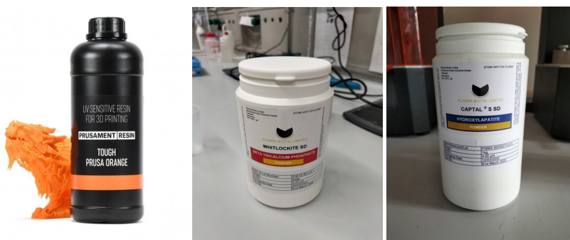
Figura 2.6 Resina polimerica e polveri bioceramiche utilizzate per la produzione dell'inchiostro: da sinistra a destra sono riportate la resina Tough Prusa Orange , la polvere di \beta -TCP WHITLOCKITE SD e la polvere di HA CAPTAL SSD .
