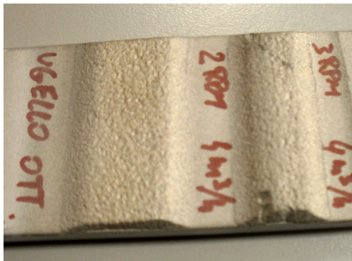
Figura 4.2. Rivestimenti di Wasp1 su substrato di alluminio. Sono evidenti i crateri sulla superficie causati dalla collisione di aggregati formati durante il clogging dell'ugello.
