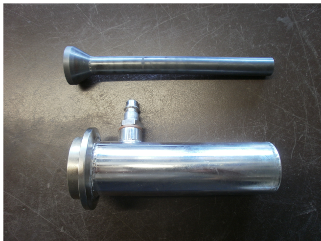
Figura 3.6. Ugello di de Laval Type 24 MOC in SiC (sopra) con il relativo sistema di raffreddamento ad aria compressa (sotto).
