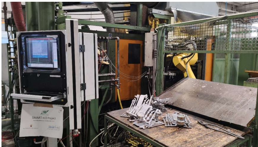
Figura 4.1 isola di pressocolata utilizzata per la campionatura con centralina di acquisizione Electronics (a sinistra).
