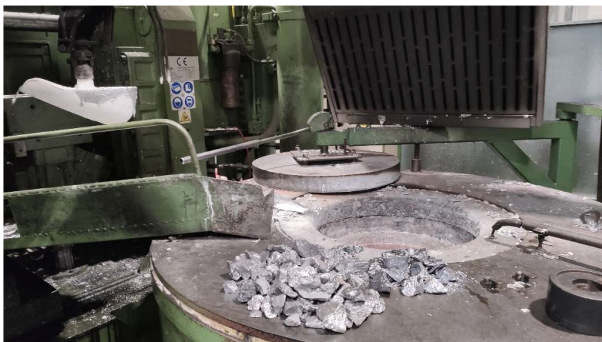
Figura 4.4 aggiunta di silicio rispetto alla lega base AlSi_{10}MnMg .
