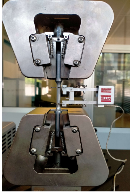
Figura 4.6 provino a sezione circolare soggetto alla prova di trazione statica.
