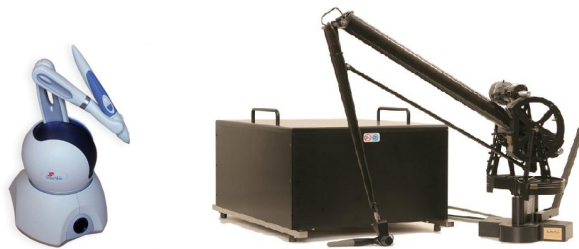
Figura 4: Due dispositivi aptici in commercio: PHANTOM Desktop Device e PHANTOM Premium Device
