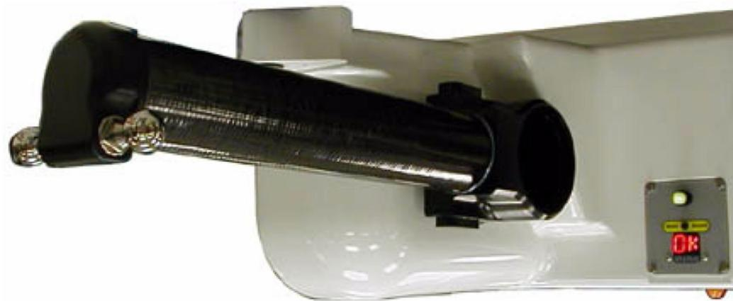
Figura 3.2: Particolare del braccio superiore o link 1
