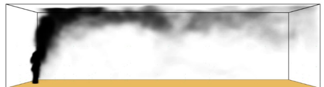
Figura 5.62: evoluzione del pennacchio di fumi nel caso di combustione del polistirene in condizioni di leggera stabilità e vento debole a t=300s
