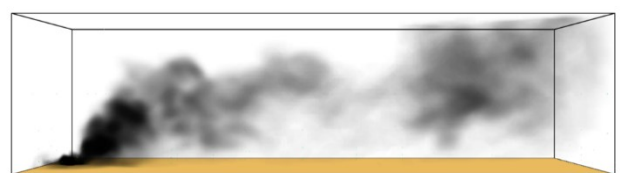
Figura 5.33: evoluzione del pennacchio dei fumi, a 300s dall'inizio della combustione di polipropilene in condizioni di leggera instabilità atmosferica e presenza di vento forte ( v=4\text{m/s} )
