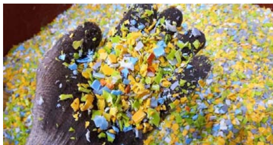
Figura 2.3: esempio di materiale plastico ridotto in scaglie (foto: Plastilab Green Innovation)
