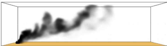
Figura 5.7: evoluzione del pennacchio dei fumi, a t=60s , nel caso di combustione del polietilene in condizioni neutre di stabilità atmosferica e presenza di vento forte ( v=4m/s )
