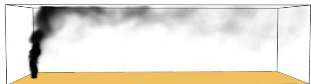
Figura 5.4: evoluzione del pennacchio dei fumi, a t=300s , nel caso di combustione del polietilene in condizioni di leggera stabilità atmosferica e presenza di vento debole
