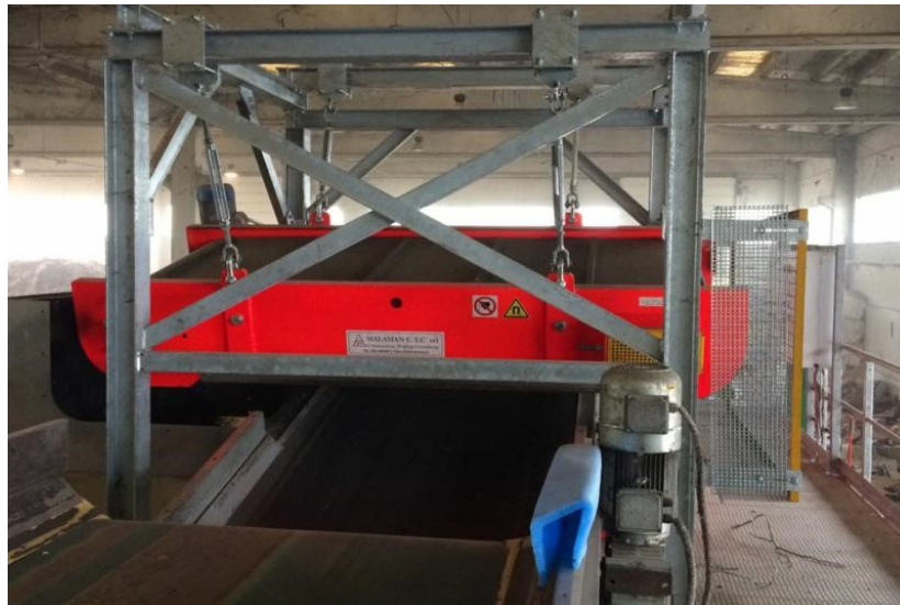
Figura 2.7: Processo di separazione dei materiali ferrosi (Foto: ditta Malaman -Tecnologie per la separazione magnetica)
