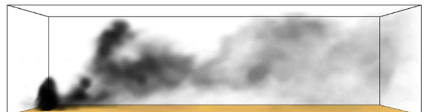
Figura 5.8: evoluzione del pennacchio dei fumi, a t=300s , nel caso di combustione del polietilene in condizioni neutre di stabilità atmosferica e presenza di vento forte ( v=4m/s )
