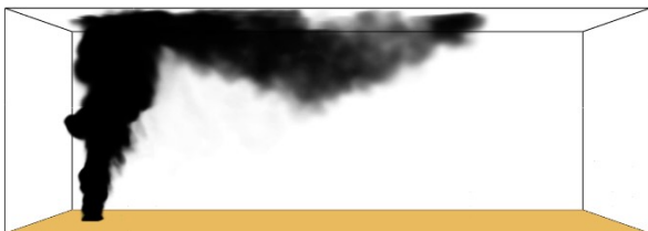
Figura 5.69: evoluzione del pennacchio di fumi nel caso di combustione del polistirene in condizioni di forte instabilità e vento debole, a t=60s (dimensioni vent 5m x 5m)
