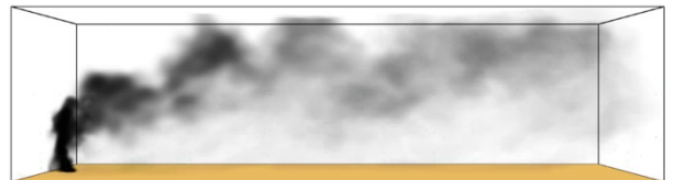
Figura 5.6: evoluzione del pennacchio dei fumi, a t=300s , nel caso di combustione del polietilene in condizioni di leggera instabilità atmosferica e presenza di vento forte ( v=4m/s )
