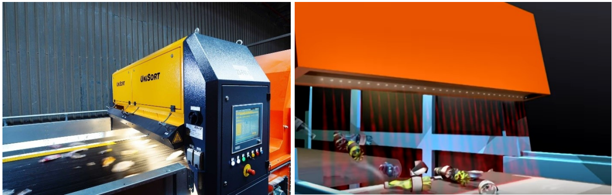
Figure 2.11 e 2.12: Separatore a raggi infrarossi. A destra, macchinario in funzione (Foto: Steinert). A sinistra, ricostruzione grafica. Questa informazione attiva immediatamente un getto d'aria che investe il prodotto analizzato e
