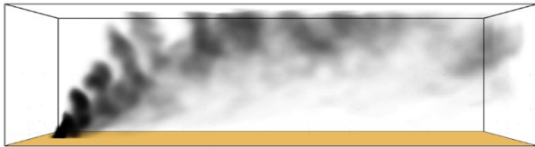
Figura 5.5: evoluzione del pennacchio dei fumi, a t=60s , nel caso di combustione del polietilene in condizioni di leggera instabilità atmosferica e presenza di vento forte ( v=4m/s )
