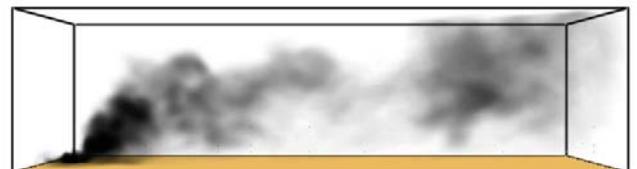
Figura 5.64: evoluzione del pennacchio di fumi nel caso di combustione del polistirene in condizioni di leggera instabilità e vento forte a t=300s
