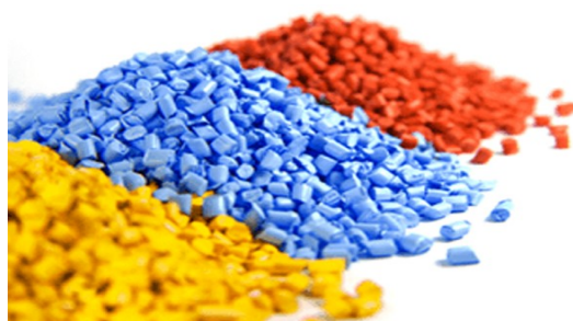
Figura 2.4: esempio di materiale plastico polimerico ridotto in granuli (foto:IPPR - Istituto per la Promozione delle Plastiche da Riciclo)
