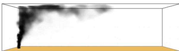
Figura 5.1: evoluzione del pennacchio dei fumi, a t=60s , nel caso di combustione del polietilene in condizioni di forte instabilità e presenza di vento debole ( v=1m/s )
