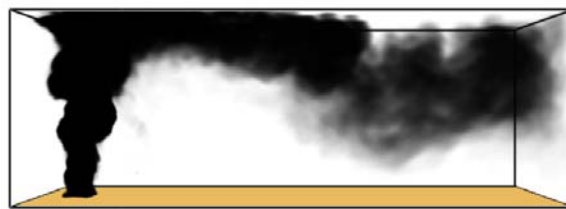
Figura 5.72: evoluzione del pennacchio di fumi nel caso di combustione del polistirene in condizioni di forte instabilità e vento debole, a t=180s (dimensioni vent 10m \times 10m )
