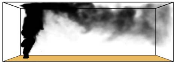
Figura 5.70: evoluzione del pennacchio di fumi nel caso di combustione del polistirene in condizioni di forte instabilità e vento debole, a t=300s (dimensioni vent 5m x 5m)
