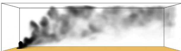
Figura 5.32: evoluzione del pennacchio dei fumi, a 60s dall'inizio della combustione di polipropilene in condizioni di leggera instabilità atmosferica e presenza di vento forte ( v=4\text{m/s} )
