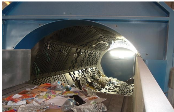
Figura 2.10: Vaglio rotante per la separazione grossolana della plastica. (Foto: Hoffman Group)
