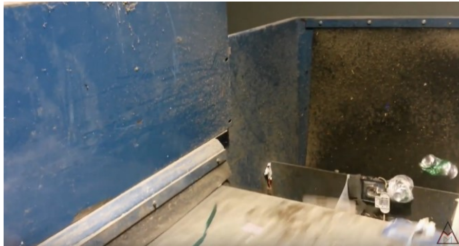
Figura 2.8: processo di separazione dei materiali non ferrosi, come ad esempio materiali in alluminio, a mezzo di nastro a correnti indotte (foto: ditta Malaman -Tecnologie per la separazione magnetica)
