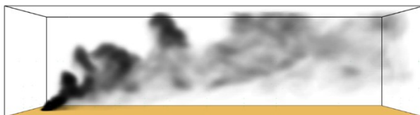
Figura 5.9: evoluzione del pennacchio dei fumi, a t=60s , nel caso di combustione del polietilene in condizioni di leggera stabilità atmosferica e presenza di vento forte ( v=4m/s )
