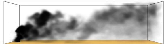
Figura 5.68: evoluzione del pennacchio di fumi nel caso di combustione del polistirene in condizioni di leggera stabilità e vento forte a t=300s
