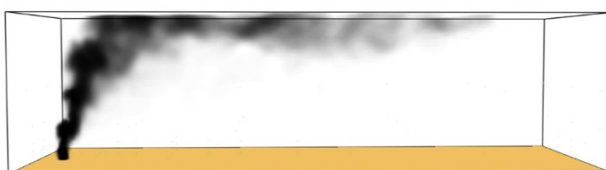
Figura 5.3: evoluzione del pennacchio dei fumi, a t=60s , nel caso di combustione del polietilene in condizioni di leggera stabilità atmosferica e presenza di vento debole ( v=1m/s )
