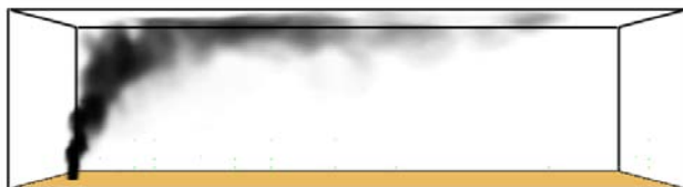
Figura 5.30: evoluzione del pennacchio di fumi, a 60s dall'inizio della combustione di polipropilene in condizioni di leggera stabilità atmosferica e presenza di vento debole ( v=1\text{m/s} )
