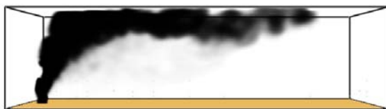
Fig. 5.101: evoluzione del pennacchio dei fumi nel caso di combustione del polivinilcloruro in condizioni di leggera stabilità e vento debole, all'istante t=60s
