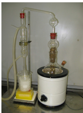
Fig. 3.5. Apparecchiatura per distillazione in corrente di vapore di tipo Cazenave-Miconi
