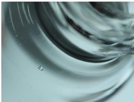
Fig. 2. Vetrini sulla superficie interna del flacone
