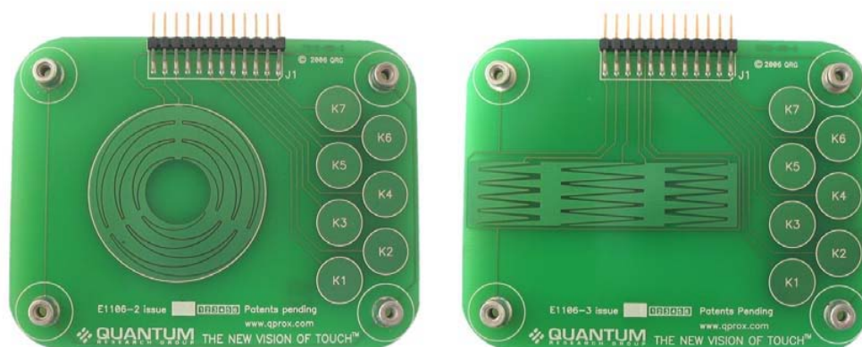
Figura 2.14: PCB della scheda touch, pad per i singoli pulsanti e le due varianti rispettivamente: wheel (destra) e slide (sinistra)[23].
