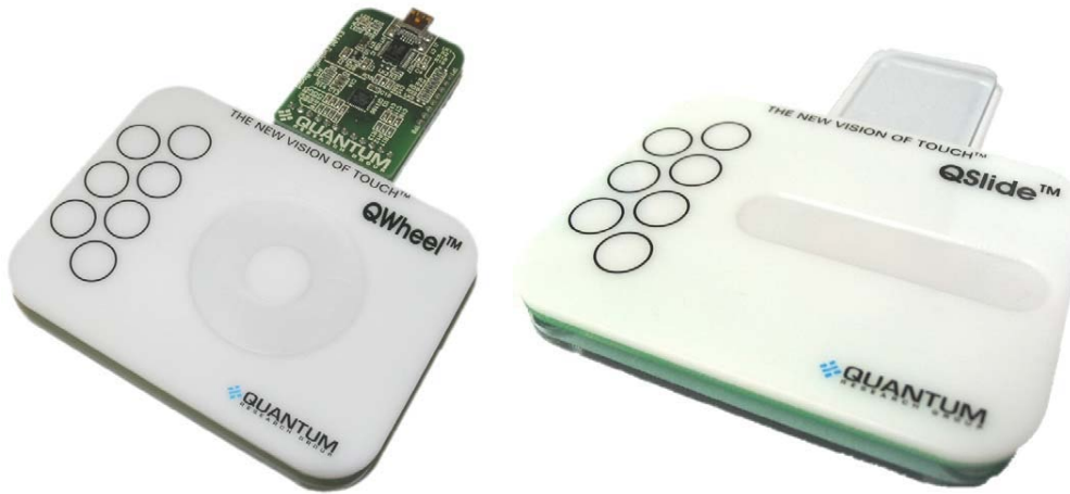
Figura 2.5: Quantum Demo Board, versione con wheel (a sinistra) e slide (a destra)[23].
