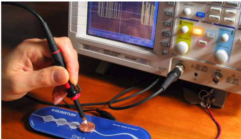
Figura 2.16: Verifica del transitorio di carica con moneta in rame e un oscilloscopio[14].
