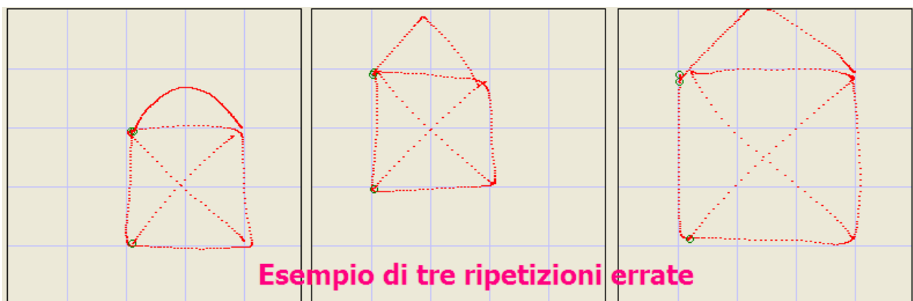
Figura 9 - Esempio di tre ripetizioni disegnate in modo sconveniente, che sono rifiutate dal sistema perché abbasserebbero la qualità di riconoscimento ed innalzerebbero il rischio di accesso da parte di impostori
