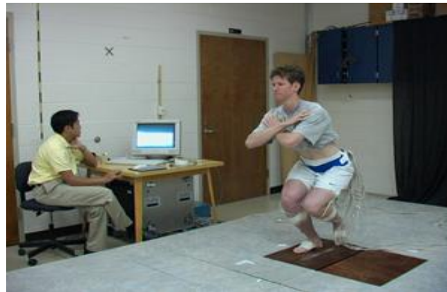
Figura 34: valutazione delle capacità di controllo con piattaforma di forza.
