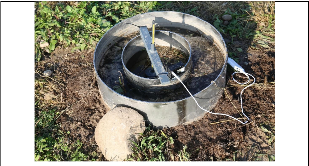
Figura 2.1: infiltrometro a doppio anello posizionato in campo, struttura galleggiante-asta graduata e macchina fotografica impostata per produrre uno scatto ad intervallo di tempo regolare.
