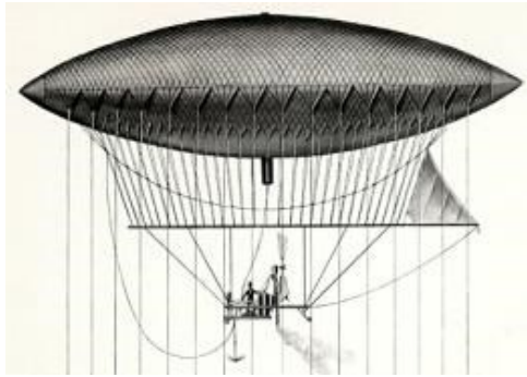
Figura 2: Pallone a idrogeno di forma affusolata costituito da un piccolo motore a vapore
