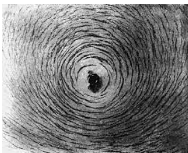
Figura 1.1: Una corrente percorre un filo (verso uscente dal foglio) e la limatura di ferro si posiziona lungo le linee di campo, che sono circolari.
