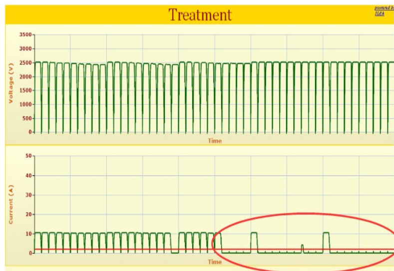
Fig.4.11: impulsi di tensione mancanti applicando 50 impulsi ad una tensione di 2500 V
