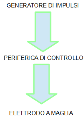
Fig.4.14: schema di collegamento delle apparecchiature utilizzate negli esperimenti
