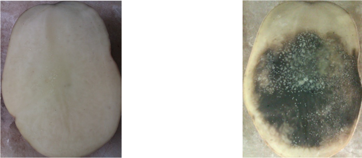
Fig.5.51: superficie del tubero subito dopo l'applicazione di 50 impulsi a 1500 V e dopo 24 ore.
