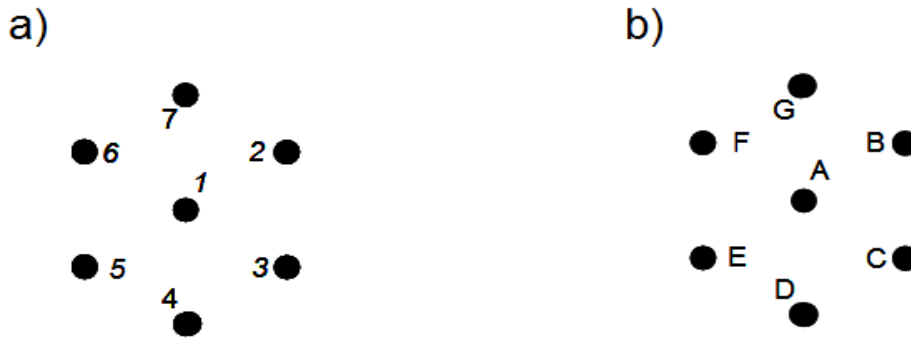
Fig.4.4: Elettrodi esagonali costituenti l'elettrodo a maglia
