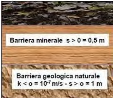
Figura 2-6: Schema di una barriera di fondo naturale per diversi tipi di discarica
