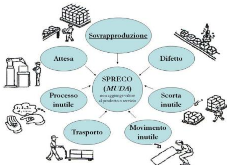
Immagine 1- I sette tipi di spreco (Metodi e strumenti per il Fiat Auto Production System, 2007)
