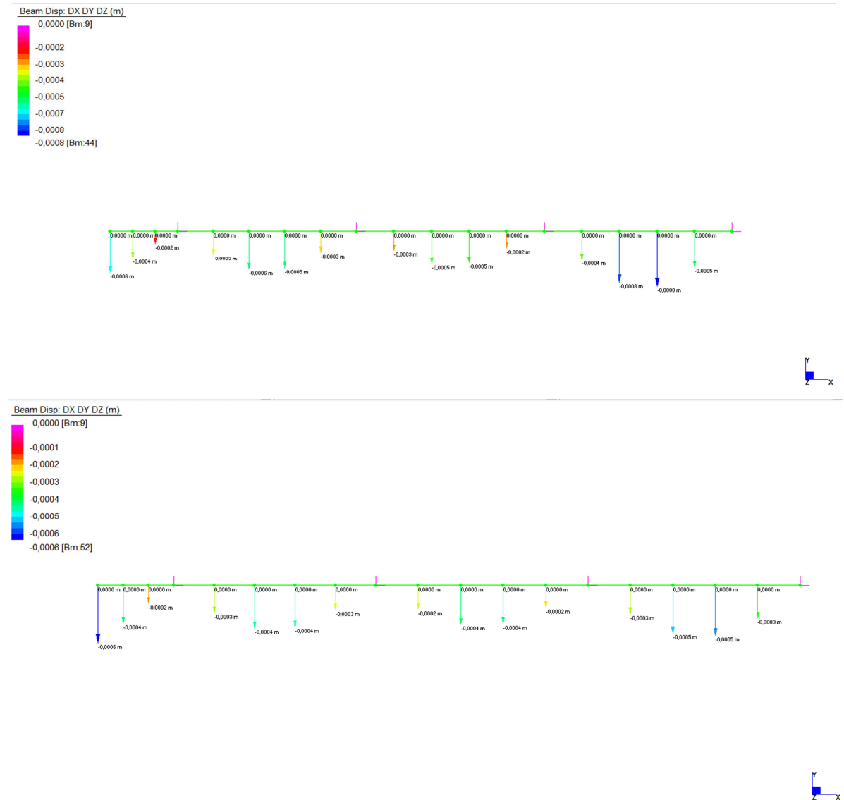
Figura 57: Diagrammi degli spostamenti, rispettivamente dei soli carichi portati e dei soli carichi accidentali
