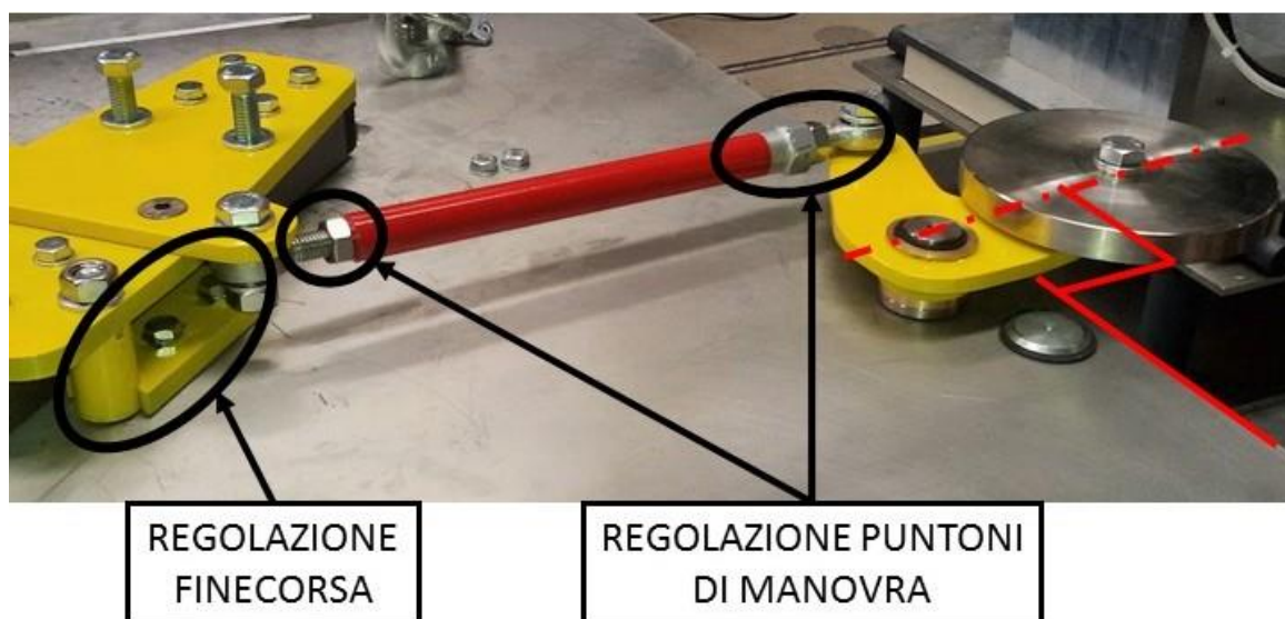
Fig. 4.6 Regolazione finecorsa e ruote di battuta.
