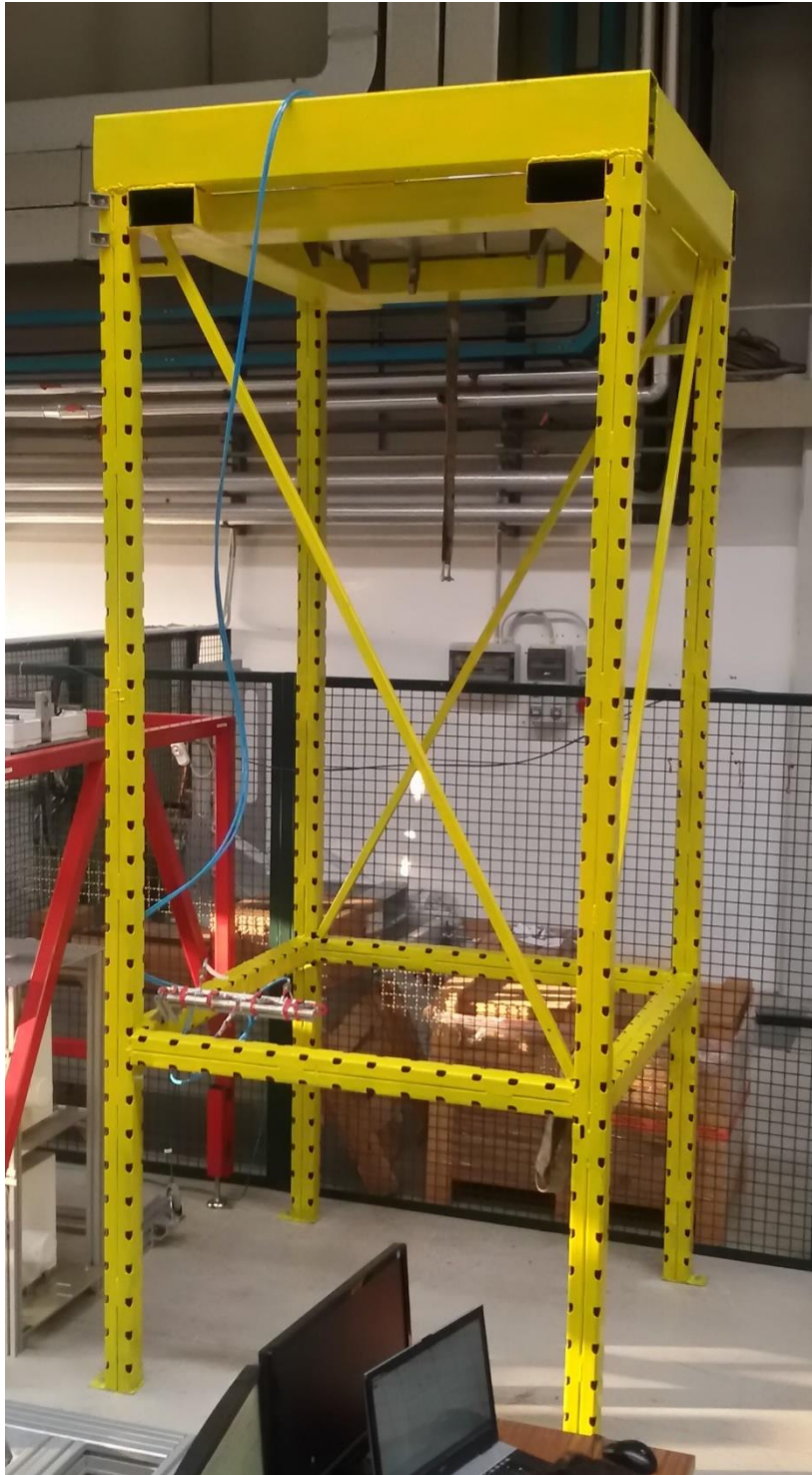
Fig. 4.9 Telaio per i test.
