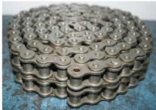
Fig. 5.12 Catena a rulli serie europea QRC 08B-2.
