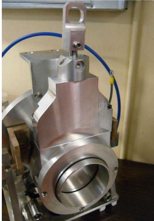
Fig. 2.13 Valvola VAT installata sulla camera target.
