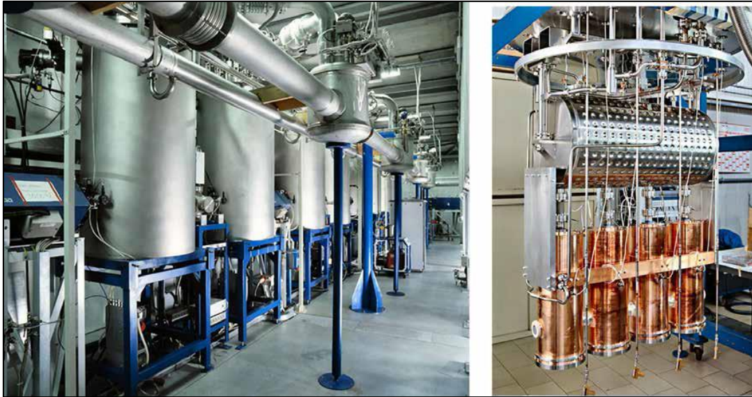
Fig. 1.16 A sinistra, un tratto del linac ALPI. In evidenza i criostati, recipienti che contengono ed isolano termicamente le cavità superconduttive (a T=-269\text{ }^{\circ}\text{C} ). A destra, l'interno di un criostato, con 4 cavità acceleranti su base di rame.
