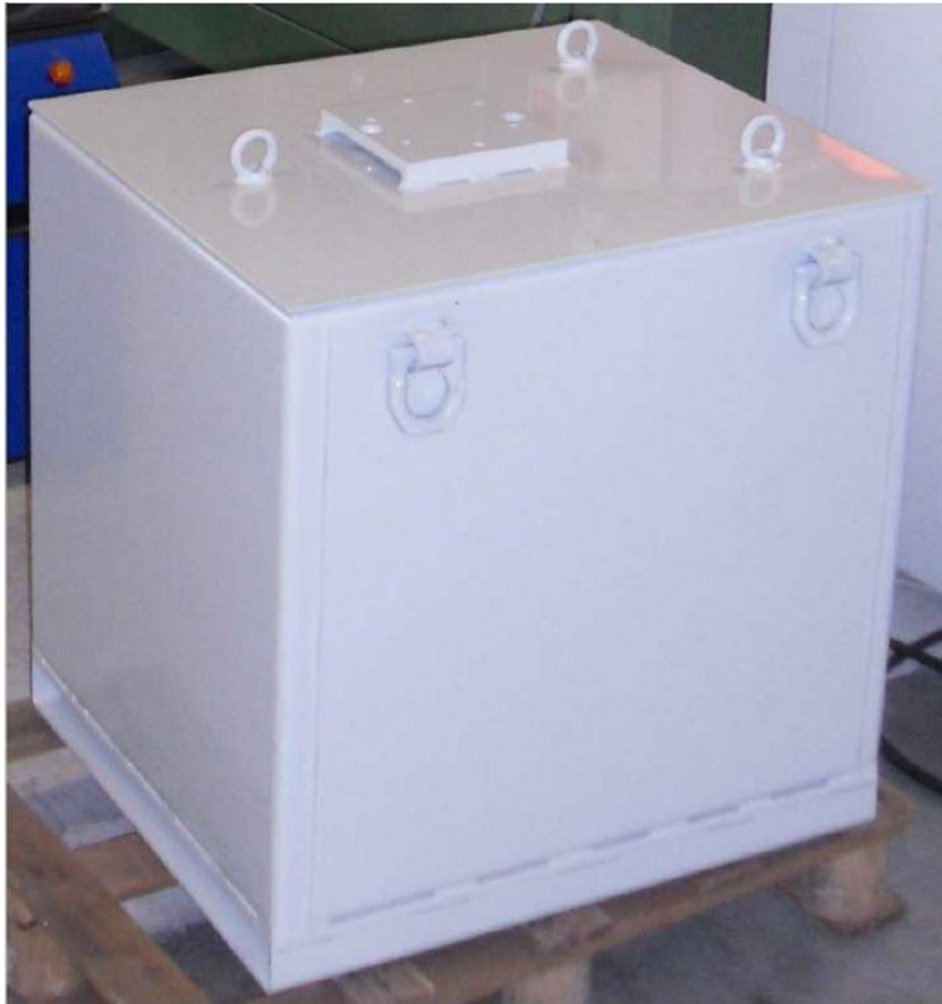
Fig. 2.21 Il sarcofago che contiene la camera target.
