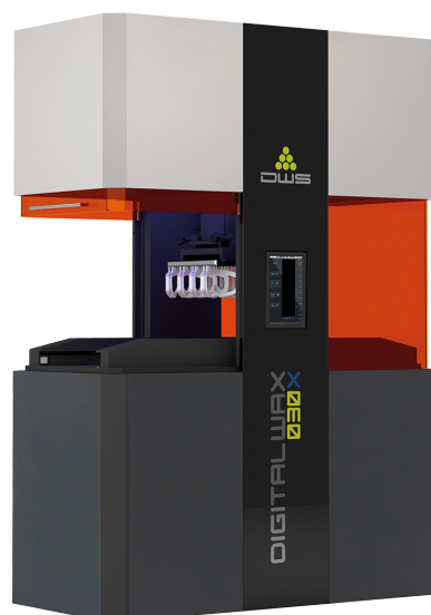
Figura 2: DWS 030X, esempio di macchinario che permette la produzione additiva mediante stereolitografia.
