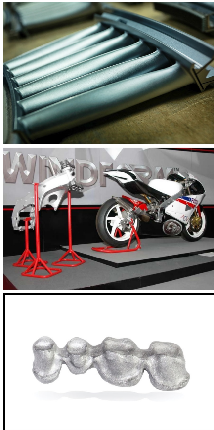
Figura 4: Dall'alto: pale di turbina realizzate da Avio Aero con tecnologia fusione a fascio di elettroni; la R250GP che ha partecipato al Motomondiale '05 e il prototipo del telaio realizzato con produzione additiva da CRP Technology; ponte dentale costruito da ZARE con sinterizzazione di metalli.
