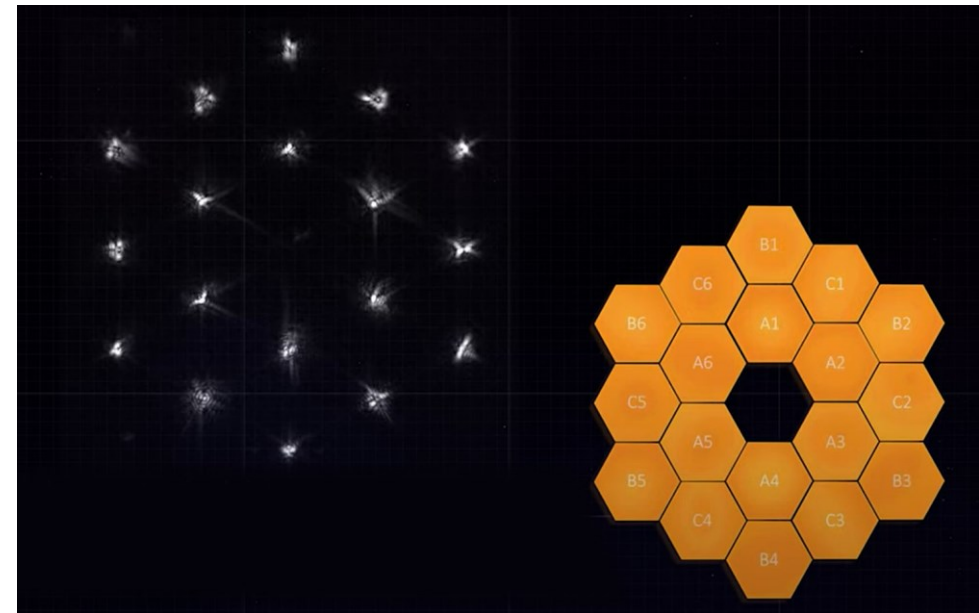
18 segmenti ordinati prima dell'allineamento (webb.nasa.gov)
