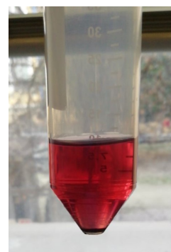
Figura 1.1: Fotografia di un campione di AuNPs in soluzione acquosa con PVA dopo essere stato centrifugato. Da notarsi il colore rosso vivo del surnatante.
